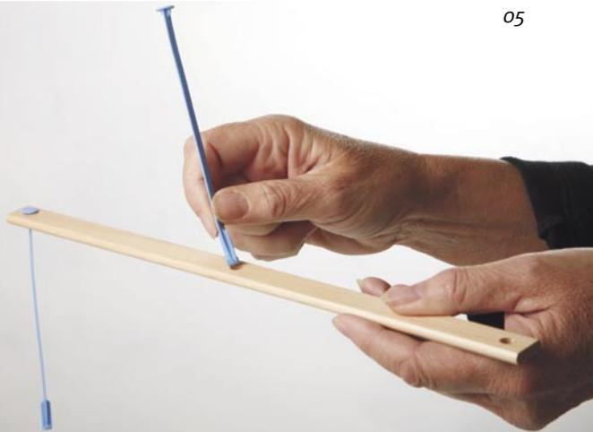
Befestige die vorderen und hinteren Kreuzleisten an Kett- und Warenbaum; verwende dafür die blauen Bänder. Zuerst schiebst Du die Nylonbänder mit den Pfeilspitzen voran durch die Löcher der Kreuzleisten.
