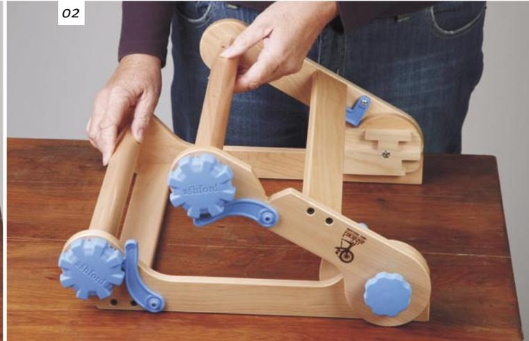
Löse die Drehknöpfe an den Seiten und klappe den Webrahmen auf.
