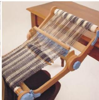
Stelle den Gatterkamm in die Reiseposition. Die Reiseposition befindet sich hinten an der Gatterkammhalterung.
