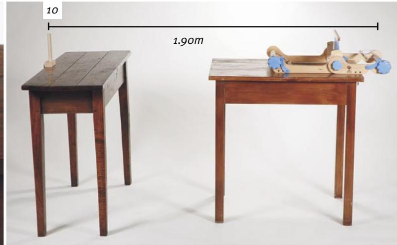
Verschiebe die Tische, bis der Kettdübel 1,90 m von der hinteren Kreuzleiste entfernt ist.
