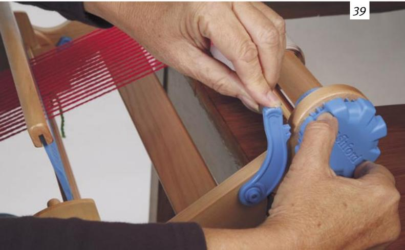
Wiederhole die ersten zwei Reihen, bis du etwa 10 cm vom Gatterkamm entfernt bist. Jetzt musst Du das Gewebe auf den Warenbaum aufwickeln. **PARKE DEN GATTERKAMM IN DER RUHEPOSITION.** Löse die hintere Bremse und wickle ein Stück der Kette ab.
