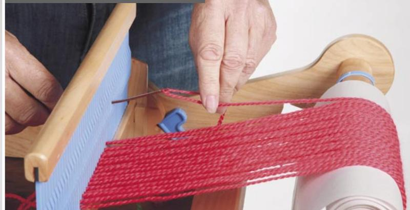
Hebe die ersten zwei Fäden ganz links an die Oberseite vom Schlitz. Schaue hinter den Gatterkamm und ziehe vorsichtig den linken Faden aus dem Schlitz. Der andere Faden bleibt im Schlitz. Benutze den Einziehhaken, um diesen Faden durch das Loch auf der linken Seite des Schlitzes zu ziehen. Wiederhole dies bei allen Schlitzes. Jetzt sind die Fäden in allen Löchern und Schlitzes.
