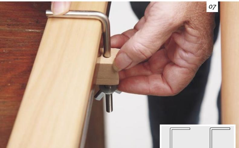
Setze die Klammern zusammen. Klemme den Webrahmen mit der Rückseite zur Tischkante fest.
