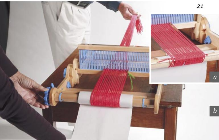
a. Stelle Dich hinter den Webrahmen. Drehe den hinteren Griff auf Dich zu, bis die hintere Kreuzleiste auf den Kettbaum aufgewickelt wurde. Lege das Papier ein. b. Das Papier legt sich zwischen die Kettfäden, während Du die Kette auf den Kettbaum wickelst. Dies trennt die Fäden und hält die Spannung gleichmäßig. Füge mehr Papier ein, während Du wickelst.
